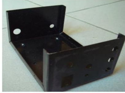
Güç kaynağı kutusunun gövdesinin bükülmüş hâli
