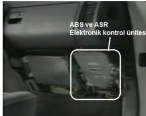
Resim 2.1: ABS ve ASR elektronik kontrol ünitesi ve araç üzerindeki yeri
