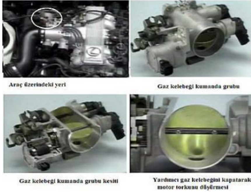
Resim 2.4: Motor torkunu kontrol eden kumanda grubu
