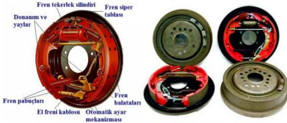
Resim 2.1: Kampanalı tekerlek fren sistemi
