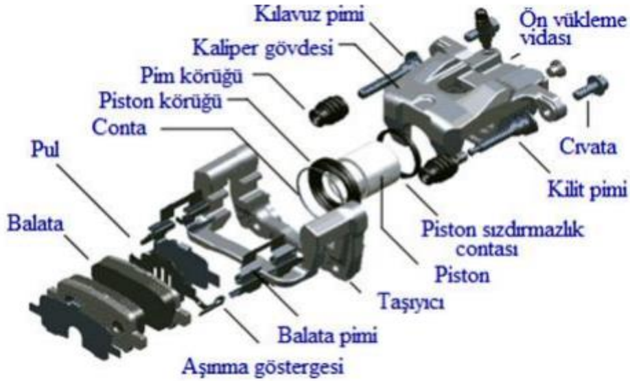
Şekil 1.8: Fren kaliperinin parçaları
