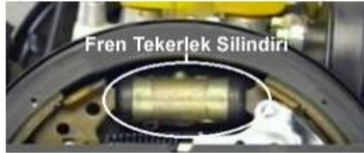
Resim 2.2: Fren tekerlek silindirinin araç üzerindeki yeri
